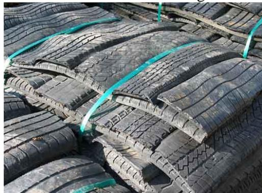
Drainage : l'utilisation de pneus ligaturés entre eux et mis en place sous forme de tube permet le drainage de fossés et de parcelles.
