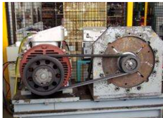
Figure 5.9: Banc pour les essais en génératrice
