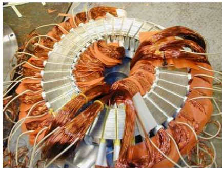
Fig. 1.7 : Bobinage réparti pour machine à flux axial [PAR 05]
