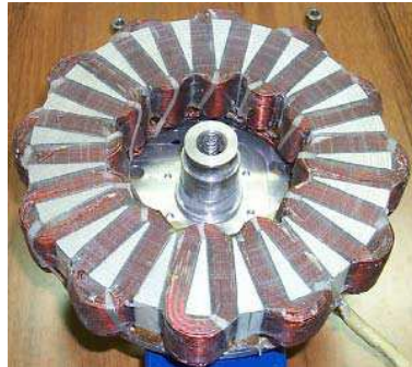
Fig. 1.8 : Bobinage concentré pour machine à flux axial [MAR 06]
