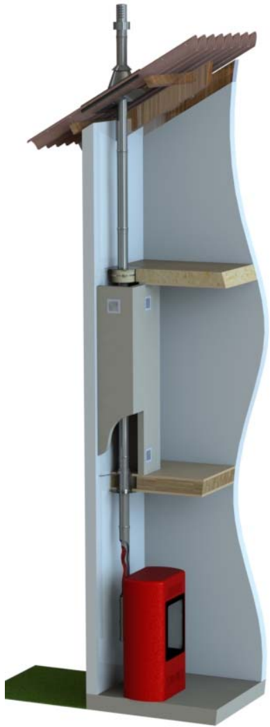
Figure 5.1a – Traversée de plancher Système d'isolation DINAKISOL
