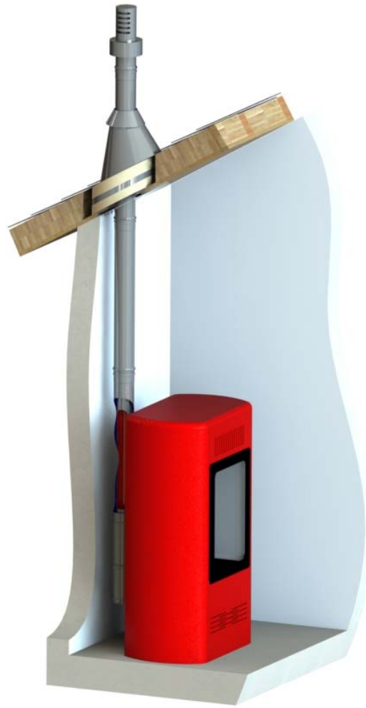
Figure 5.1b – Traversée de rampant Système d'isolation DINAKISOL
