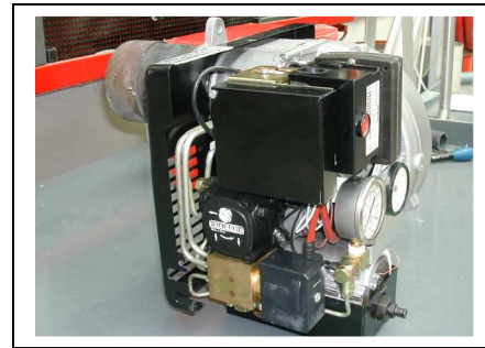
Brûleur spécial Riello/Cirad ; 34 à 110 kW Huile de coton brute, 2007. (photo Cirad)
