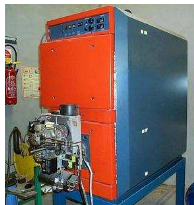
Brûleur fonctionnant à huile de colza, de tournesol, de palme, de coprah (pulpe séchée de la noix de coco) ou bien encore de pourghère. Photo CIRAD
