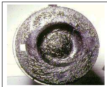
Piston injection directe : 21 heures huile végétale Photo CIRAD
