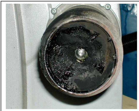
Déflecteur d'air après 4 jours à 50/50, tournesol/fioul (à droite : après nettoyage) photo Cirad
