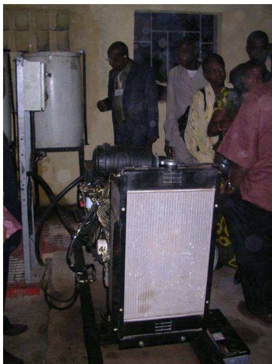
Moteur fonctionnant à l'huile de Pourghère, Bamako Mali nov. 1994 www.peracod.net
