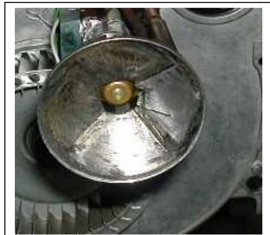
Déflecteur d'air après 4 jours à 50/50, tournesol/fioul (à droite : après nettoyage) photo Cirad
