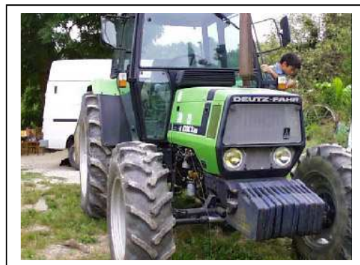
Tracteur Deutz à injection indirecte. Huile de colza, France, 1998 Photo CIRAD
