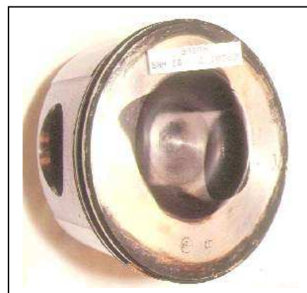
Piston modifié après 500 heures à huile de colza Photo CIRAD
