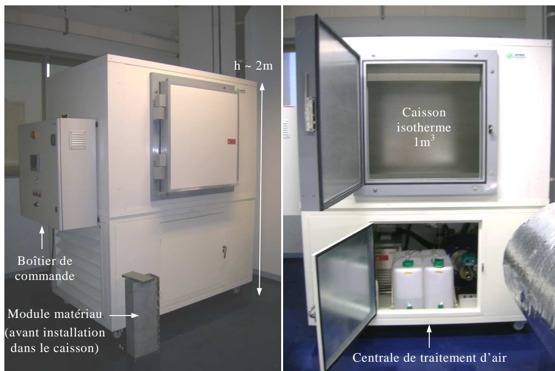
Figure 4.8 : Banc de test pour réacteur thermochimique
